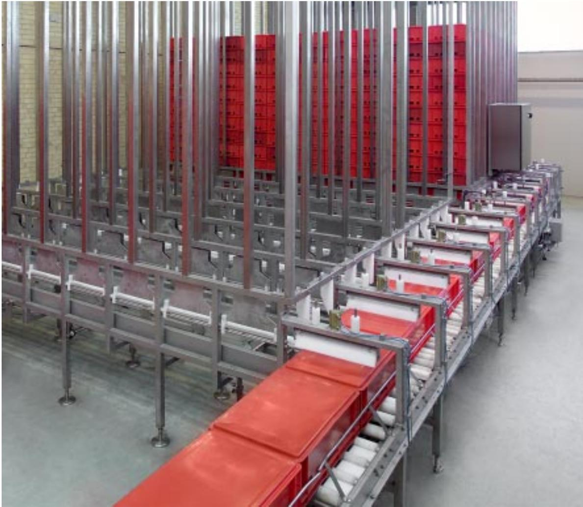
*El nuevo almacén de alta capacidad cada línea puede contener hasta 10 pilas de bandejas E2, y se pueden apilar hasta 37 capas de bandejas, sin espacio libre.
